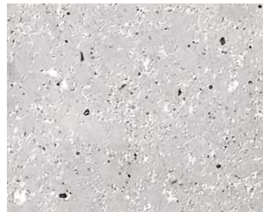
Mikrostruktura cermetalu MD220
