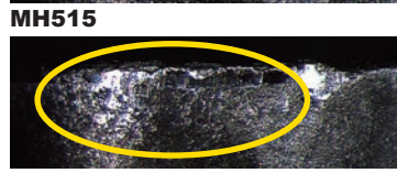
従来品 コーティング層の剥離による損傷
